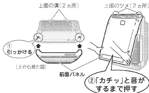
前面パネルが正しく装着されていないと安全スイッチが作動し、運転しない場合があります。
